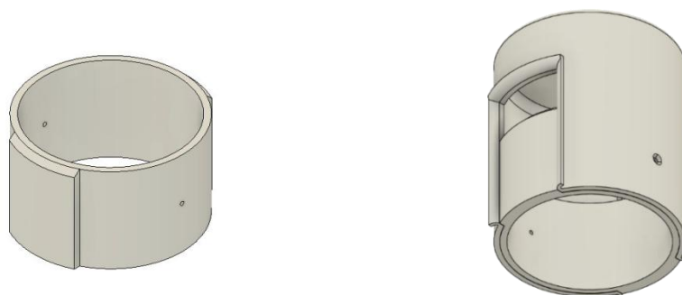
Рис. 3. Нижняя часть корпуса (слева) и общий вид собранной конструкции (справа)
