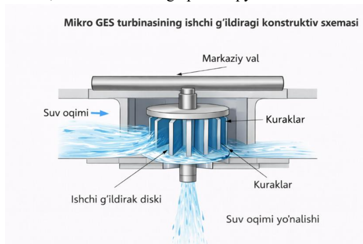
1-rasm. Mikro GES turbinasining ishchi g'ildiragi konstruktiv sxemasi
