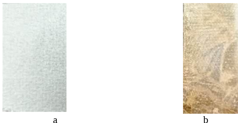
Рис. 1. Образцы инкапсулянта ЭВА до начала эксплуатации (а) и через 14 лет (б)
