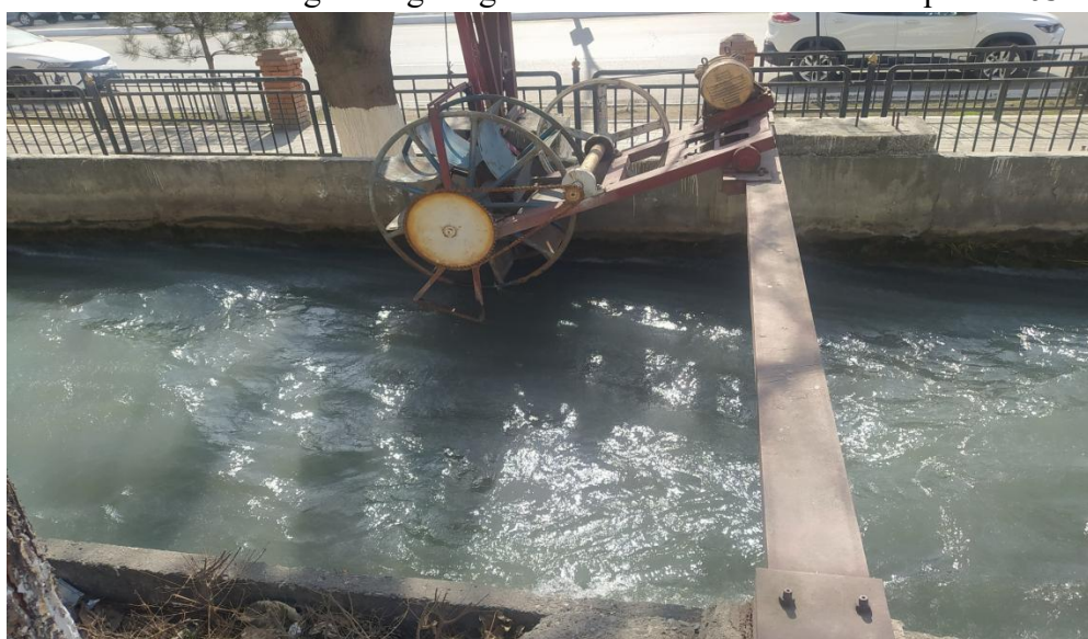
2-rasm. 5 kVt mikro-GES ishchi g'ildiragi konstruksiyasi.
